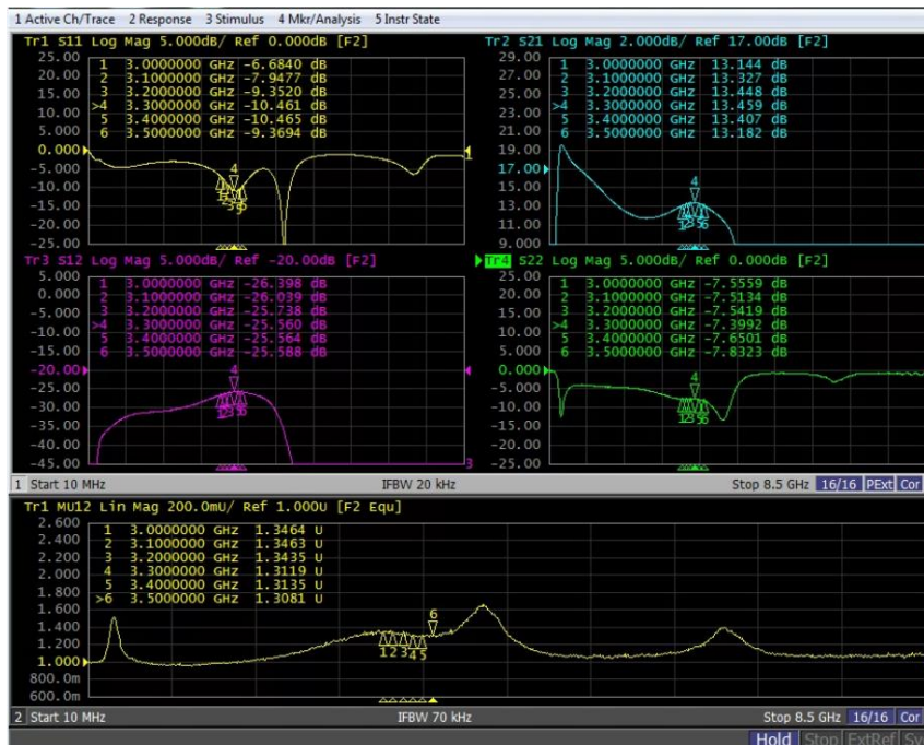
Figure 6.1.1. S parameters of TA9210D-EVB-J 24 V, 30 mA
