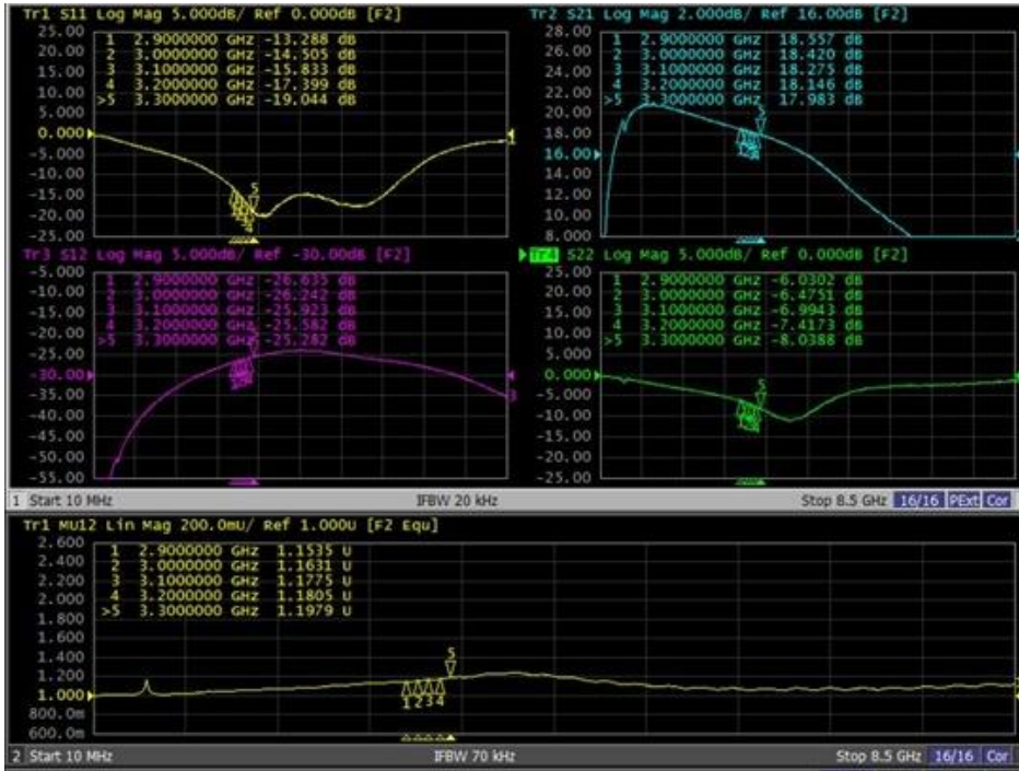
Figure 6.1.1. S parameters of TL0375J-EVB-D
